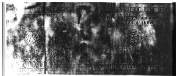
Рисунок 12 – Общий вид поддельной купюры достоинством 100 долларов США, выполненный в поле токов высокой частоты
